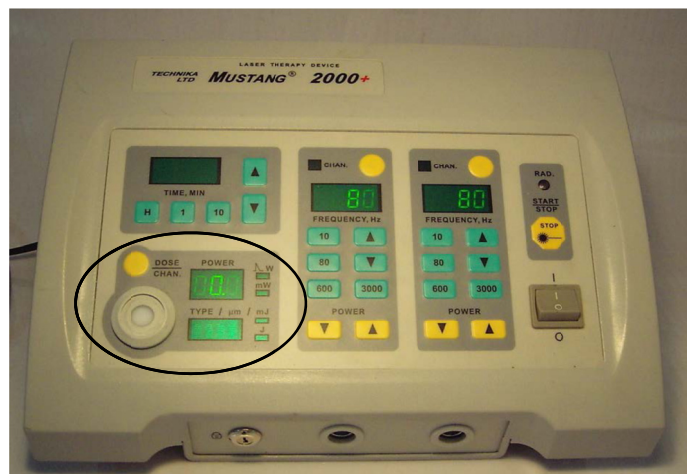
شکل ۴-۵: یک دستگاه لیزر کم توان دارای بخشی جهت نمایش "Power" و "Dose" (بخش داخل
