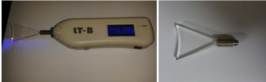
شکل ۳-۴: نمایی از یک نازل دهانی شکل ۳-۵: نازل دهانی متصل به پروب لیزرآبی
