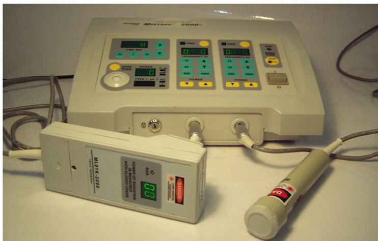
شکل ۴-۴: یک دستگاه لیزر کم توان دارای دو کانال خروجی که پروب‌های قلمی و کلاستر به آن متصل شده‌اند.
