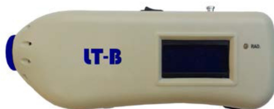
شکل ۴-۲: یک نمونه از پروب دستی لیزر آبی با طول موج 450nm
